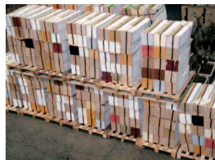
Une palettisation mal faite peut amoindrir la qualité des cahiers et provoquer des accidents. Sur cette photo, on voit que le lien de cerclage des cartouches de la palette inférieure est trop étiré, ce qui déstabilise la deuxième palette en partant de la droite. Photo Muller Martini
