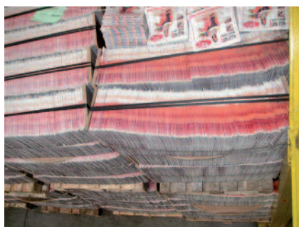
Exemple de cartouche mal constituée : cahiers mal alignés, forme incurvée. Photo Muller Martini
