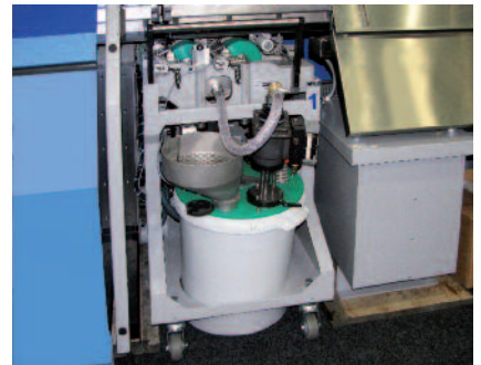
Poste de colle froide avec seau de colle intégré. Photo Muller Martini
