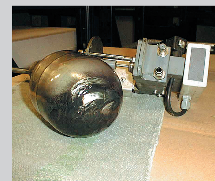
L'accumulo di sporco sul galleggiante dello stabilizzatore dell'alcol ne fa aumentare il peso e può modificare il contenuto di alcol nella soluzione di bagnatura. Foto Technotrans.
