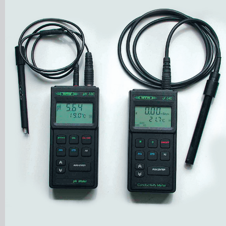
Gli strumenti di monitoraggio del sistema di bagnatura comprendono un misuratore digitale di conducibilità, un misuratore di pH e un termometro a sonda (i dispositivi digitali sono più precisi e più facili da calibrare), un idrometro per testare la percentuale di IPA e un tester per la durezza dell'acqua. Foto Sun Chemical.
