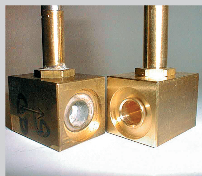
Corrosione di parti meccaniche derivante dall'uso di un additivo non corretto o aggressivo o di alcol di bassa qualità. Foto Technotrans.
