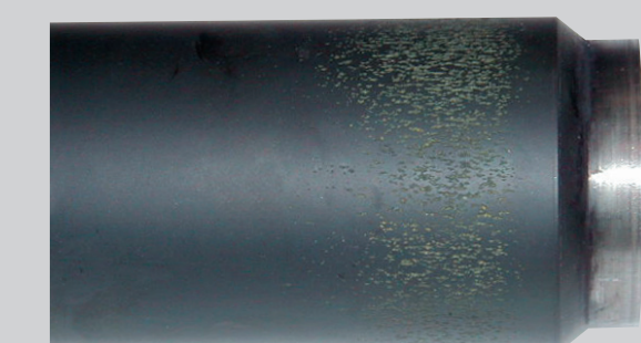
Rulli danneggiati a causa di regolazioni non uniformi che hanno aumentato notevolmente la temperatura di funzionamento. Foto Böttcher.
